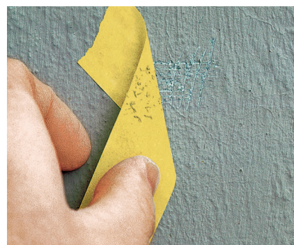
Resultat av tvärskäringstest på betongyta. Många partiklar har lossnat och fastnat på tejen: Ytan lämpar sig endast delvis för maskering
