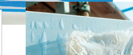
Självhäftande skyddsfolie som har applicerats på en anodiserad aluminiumyta och har bubblor och veck
