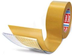
Bandă cu adeziv acrilic pe bază de apă și rețea din PET pentru montare în interioare auto, 75µm
