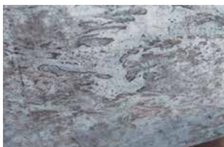
Oppervlakteverandering door condensatie op zinkplaat
