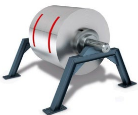
金属コイル端部の 仮固定
