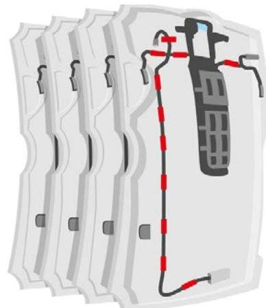
Fixation des faisceaux sur le pavillon
