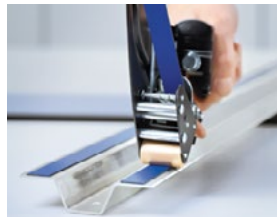
Dévidoir manuel équipé d'un dispositif de contrôle de pression
