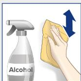
Nettoyez la surface avec de l'alcool dénaturé ou un nettoyant pour vitres pour enlever la poussière et la graisse. Attendez que la surface sèche avant de poser le ruban adhésif de fixation.
