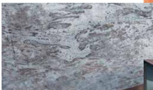
Changement de surface dû à la condensation sur une tôle de zinc
