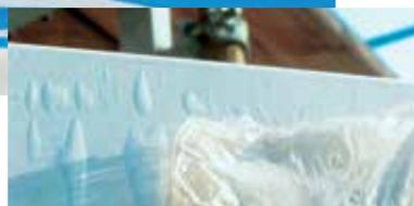
Application d'un film de protection auto-adhésif sur une surface en aluminium anodisé présentant des bulles et des rides
