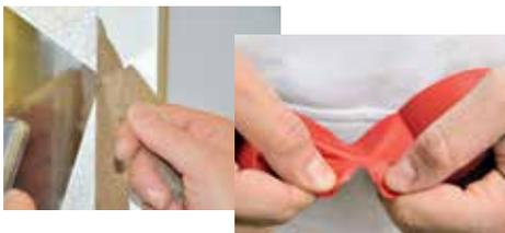
**Difficiles à appliquer, difficiles à retirer :** Les rubans de masquage de base ne peuvent pas être déchirés proprement, ce qui rend difficile le masquage précis des coins. De plus, ces rubans se déchirent souvent lorsqu'on les retire
