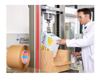
tesa® 51345 a été développé pour renforcer les zones critiques soumises à des contraintes, telles que les poignées latérales percées, les poignées d'ouverture et les poignées supérieures. Des tests ont prouvé que ce ruban offre la même résistance et performance que les rubans traditionnels à base de film du marché.
