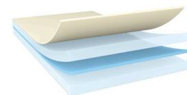
tesa® 58334 è un nastro biadesivo trasparente in PET differenziato da 100µm, dotato di adesivo acrilico modificato con resina.
