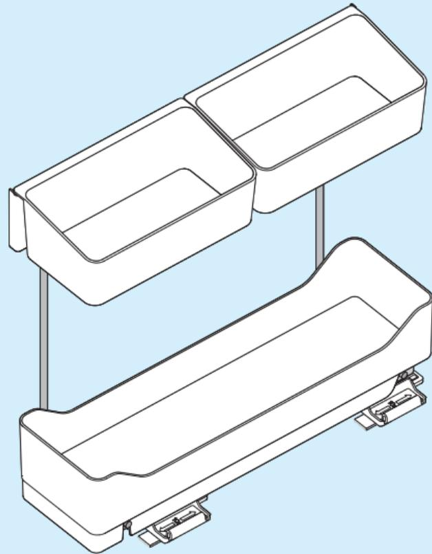
Le montage est possible sur les deux côtés de l'armoire, également sur le côté de la porte.
