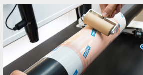
Montaje de planchas
