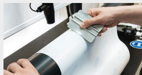
Montaje de la cinta
