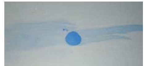
Si los restos de tinta permanecen, se considera que la superficie es de baja calidad.
