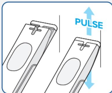
Al presionar, asegúrese de que la línea de la parte superior de la herramienta de presión se cierra, entonces está presionando lo suficiente.
