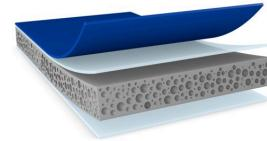
Cinta de espuma acrílica de doble faz de 1,1 mm para montaje de piezas accesorias exteriores automotrices
