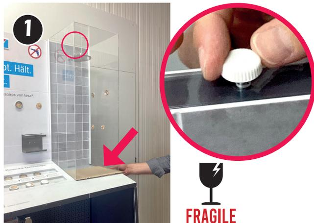
Retirar a protecção de navegação de debaixo da capota e retirá-la cuidadosamente do visor. Para o fazer, primeiro soltar o parafuso na parte superior. **Atenção, risco de quebra!**
