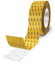
130 μm ενισχυμένο ακρυλικό κολλητικό στρώμα με βάση το νερό, νήματα PET για εφαρμογές στο εσωτερικό των αυτοκινήτων
