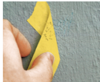
Resultat Gitterschnitt-Test auf einer Betonoberfläche. Auf dem abgezogenen Klebeband haften viele Partikel: Die Fläche ist nur bedingt zum Abkleben geeignet
