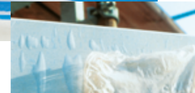
Nicht blasen- und faltenfreie Applikation selbstklebender Schutzfolie auf Eloxal
