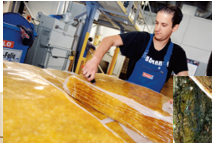
Vorbereitung Klebmasse-Produktion: Auspacken von Naturkautschukballen
