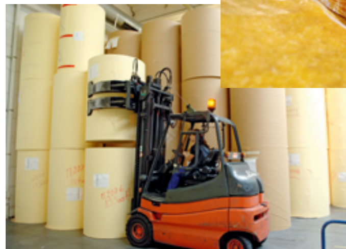
Rohstoff für die Produktion von Abklebebändern: Krepppapier-Großrollen
