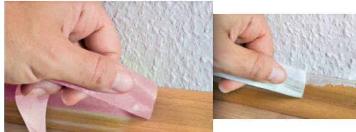
Ausriss der Holznachbildung; mit Standardkrepp hohes Risiko, wenn im nassen Zustand abgezogen wird. Mit tesa Präzisionskrepp® 4333 Sensitive keine Beschädigung
