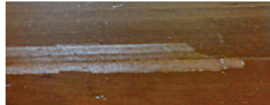
Lackabrisse bei UV-gehärtetem Fertigparkett durch ein zu stark klebendes Abdeckband
