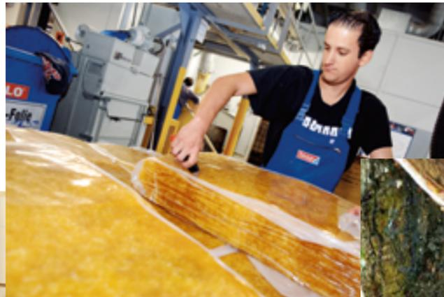
Vorbereitung Klebmasse-Produktion: Auspacken von Naturkautschukballen
