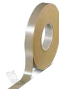
tesa® **FUSE 45012** ist ein hitzeaktiviertes Haftklebeband und besteht aus einer 1,2 mm dicken Spezialklebmasse und einer transparenten Polyesterabdeckung. Das Produkt wurde speziell entwickelt, um Metallteile vor der Pulverbeschichtung miteinander dauerhaft und sicher zu verkleben. Das Klebeband wird vor dem Einbrennprozess verklebt und ent-
