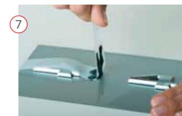
Ziehen Sie die Folie sofort nach Aufbringen in einem Winkel von 90° ab. Mit dieser Methode lassen sich größere Rückstände schnell entfernen.
