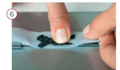
Prüfen Sie durch Druck mit dem Daumen, ob die Folie komplett auf den Kleberückständen haftet. Tragen Sie unbedingt Schutzhandschuhe, da die Rückstände noch heiß sein können.
