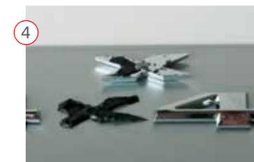
Führen Sie die Angelschnur in sägenden Bewegungen durch das Klebeband, bis das Anbauteil vom Blech gelöst ist.
