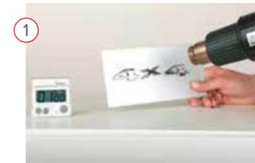
Erwärmen Sie das Anbauteil mit einem Heißluftföhn mindestens eine Minute auf 80–100 °C.\*
