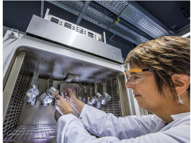
Die Haftfestigkeit und Klebebeständigkeit von Tapes werden mithilfe unterschiedlich schwerer Gewichte getestet. Nach erfolgreich bestandener Hängepartie wissen die tesa Forscher genau, dass ein Klebeband die spezifischen Kundenanforderungen erfüllt.
