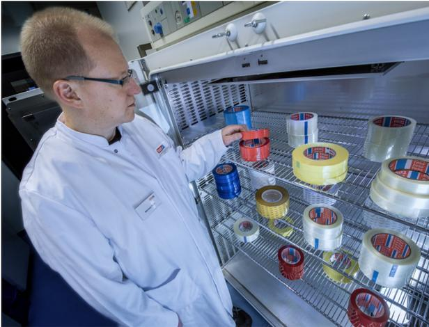
Im Bereich der Anwendungstechnik werden Produkte auf „Herz und Nieren“ geprüft. So lässt sich beispielsweise in einer Wärmekammer die Alterung der Klebebänder simulieren; innerhalb kurzer Zeit machen diese eine „Zeitreise“.
