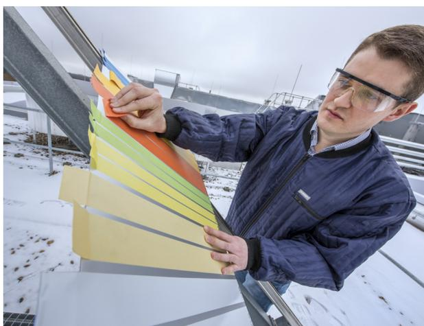
Auf dem Dach des tesa Neubaus befindet sich eine Bewitterungsanlage. An dieser können einzelne Klebestreifen, aber beispielsweise auch komplett verklebte Solarpaneele unter „echten“ Wetter-Bedingungen einem Praxistest unterzogen werden.
