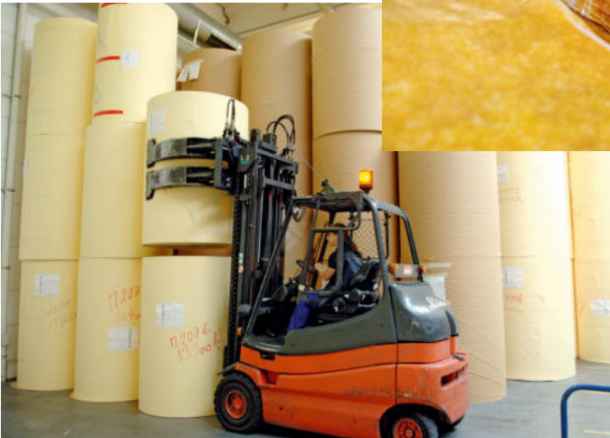
Rohstoff für die Produktion von Abklebebändern: Krepppapier-Großrollen
