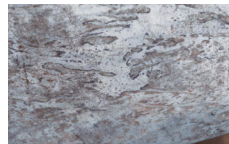
Oberflächenveränderung durch Kondenswasserbildung auf Zinkblech
