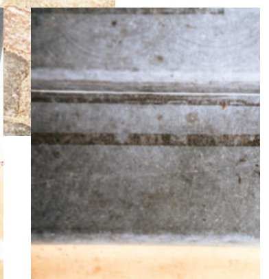
Farbveränderungen auf Naturstein (belgischer Granit, matt geschliffen) nach Klebebandeinsatz
