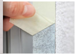
Klebmassenrückstände auf Eloxal
