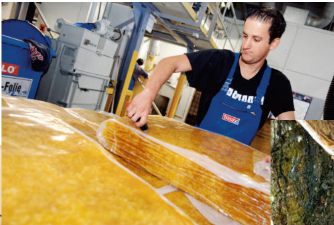
Vorbereitung Klebmasse-Produktion: Auspacken von Naturkautschukballen
