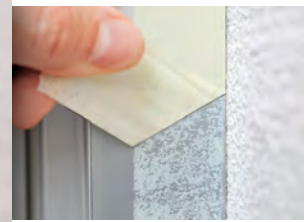
Klebmasserückstände auf Eloxal
