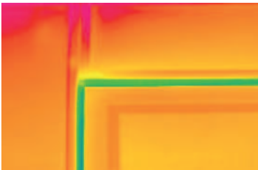
Ohne tesamoll®: Sichtbarer Wärme- und Energieverlust
