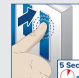
Pressen Sie diese mit den Fingern fest an: Ab fünf Sekunden Andrücken entwickelt sich die optimale Haftkraft.
