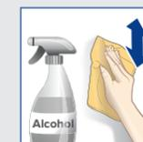
Reinigen Sie die Oberfläche mit Alkohol oder Fensterreiniger, um Staub und Fett zu entfernen. Wenn Sie das Montageband anbringen, sollte die Oberfläche wieder trocken sein.
