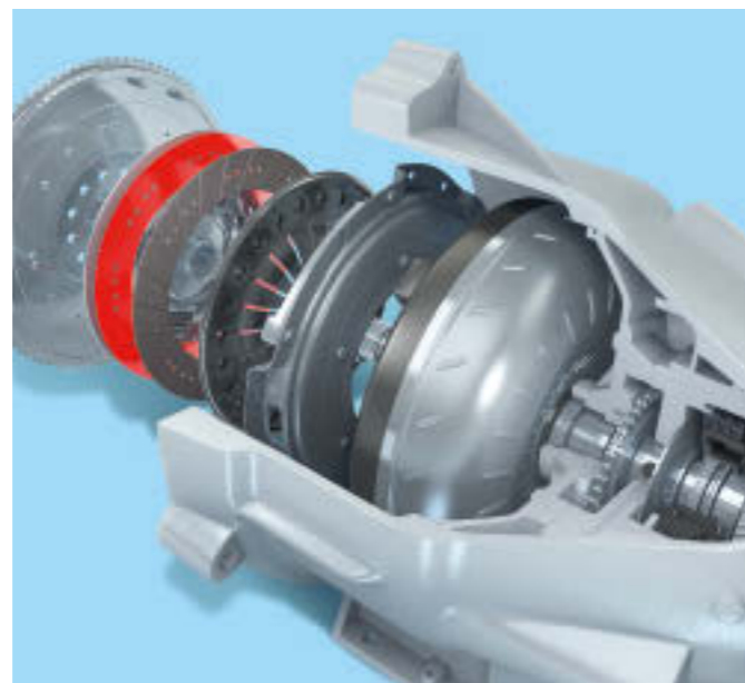
Verklebungen von Reibbelägen aus Carbon auf Metall für z.B. Kupplungsbeläge
