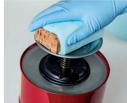
3. Befeuchten Sie das Reinigungstuch mit dem tesa Twinlock® Aktivator. (Bei dem Dispenser 4 bis 5 Mal pumpen).
