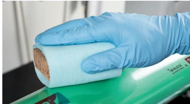
4. Aktivieren Sie die tesa Twinlock® Hülse, indem Sie das Reinigungstuch mit mittlerem Druck von einer Seite auf die andere streichen und die Hülse dabei langsam drehen.
