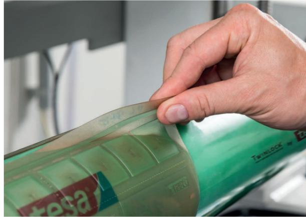
1. Entfernen Sie wie gewohnt die Druckplatte nach dem Druckauftrag.
