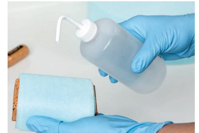
3. Wischen Sie mit dem sauberen Reinigungstuch und mittlerem Druck von einer Seite auf die andere. Reißen Sie den verschmutzten Teil des Reinigungstuches vor der nächsten Druckplatteneinigung ab.
