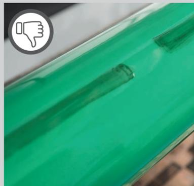
Stellen Sie sicher, dass alle Rückstände eines Primers aus vorherigen Druckaufträgen entfernt werden.
