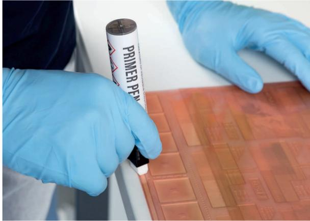
1. Legen Sie die Druckplatte mit der Rückseite nach oben auf den Arbeitstisch (Die druckende Seite zeigt nach unten).
