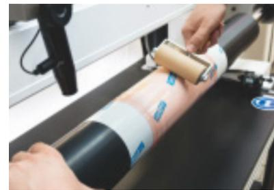
Das Klischee mit einer geeigneten Gummirolle anrollen, mindestens an den Anlaufkanten, So können Sie eine bessere Verbindung der Klebmasse zur Oberfläche als mit der Hand erzielen.
