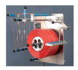
Dispensador de bobina con sistema de freno y amortiguación
